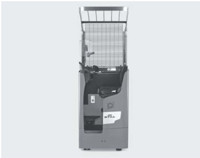
Besonders kompaktes Fahrzeugchassis für das Arbeiten in schmalen Gängen
