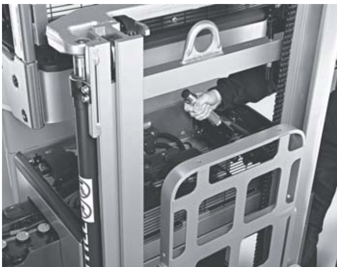
Serienmäßiger seitlicher Batteriewechsel für höchste Verfügbarkeit und Ergonomie
